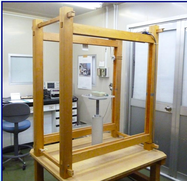
当社では、人体への暴露に関する低周波磁界および電界の測定法に関する国内規格 JIS C 1910(2004) に準拠した装置ならびに手法を用いて、交流磁界測定器の特性評価（校正）試験を行っています。
