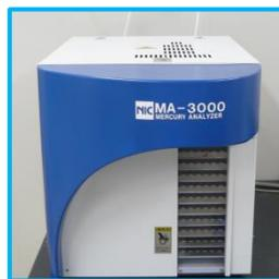
加熱気化/還元気化冷原子吸光水銀分析装置
