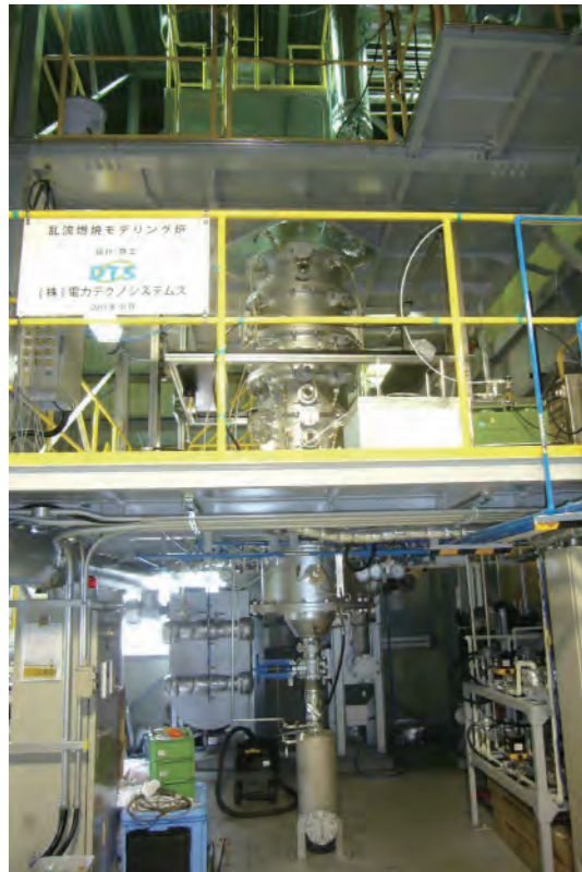
乱流燃焼モデリング炉 (一財)電力中央研究所 横須賀地区
